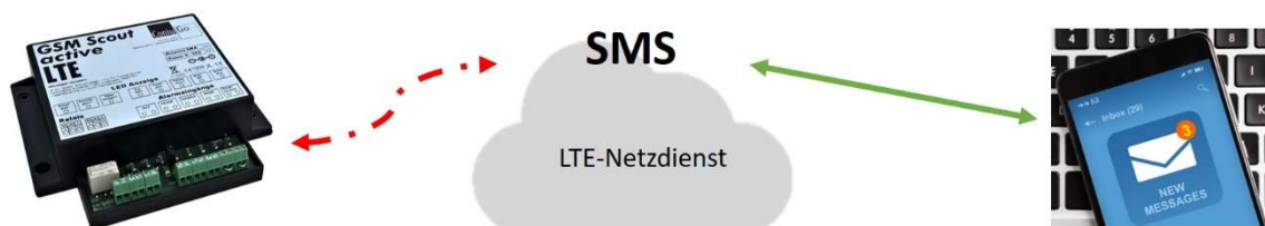
Abb. 1: Über den LTE-Netzdienst kann der Versand der SMS fehlschlagen.
